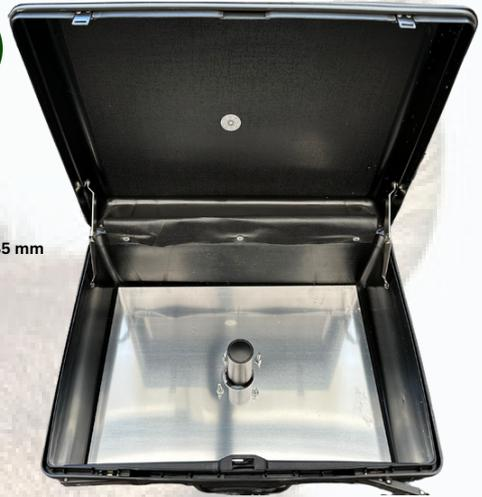
Aluminium platte 450x330x2mm mit Silikon auf dem Kofferboden befestigen als Unterstützung! Dann das Loch für den Boxenflansch **39mm** bohren und den Flansch **mittig** einsetzen und mit 4 x M8 Senkkopfschrauben + Unterlegscheiben und Muttern befestigen.
